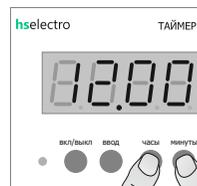
В дальнейшем, при отключении питания значения времени будут сохраняться. Благодаря установленному внутри элементу питания.
