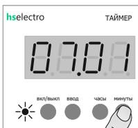
Нажмите кнопку **ввод** прибор перейдет в раздел установки времени выключения. Светодиод будет мигать зеленым цветом. Используя кнопки **часы** и **минуты** установите время выключения. Нажмите кнопку **ввод** прибор запомнит установки и выйдет в рабочий режим. Если на индикаторе высветиться надпись **Error**(ошибка) проверьте правильность установок временных значений. **Время выключения не может быть раньше чем время включения!**
