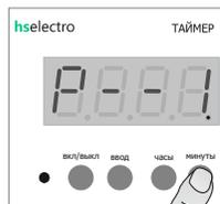
Выбрав номер программы, нажмите кнопку часы. Прибор войдет в раздел установки времени включения, светодиод мигает красным. Если нет установок на индикаторе высветятся прочерки, если была запись то высветятся старые установки.
